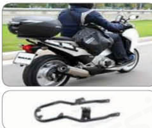
탭박스 : 승용자동차의 트렁크 같은 역할 ※ 탭박스 설치 시 필요한 브라켓(부속품)으로 하나의 구성품으로 허용
