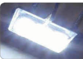
LED 변호등 변호판 시인성 향상을 위해 변경 ※ 부품(하우징)의 변경없이 광원만 교체되는 경우
